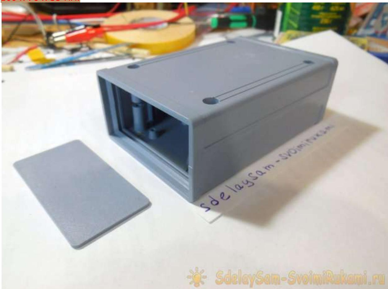
При сверлении отверстий следует учитывать габариты компонентов, которые располагаются внутри, а также диаметр отверстий для установки деталей. Соединять все детали, особенно гнездо входа звука и потенциометр громкости следует максимально короткими проводами, иначе возможно возникновение фона. Плату можно закрепить на корпусе с помощью стоек с винтиками, либо клея.
