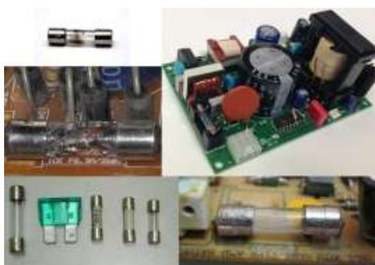
После этого осматривают наличие следов нагрева или сажи на плате и поврежденные компоненты. Рассмотрим, как выглядят неисправные электронные компоненты. Например, корпуса неисправных транзисторов и сгоревших диодов разрывает или они трескаются.
