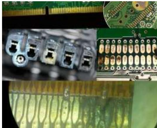
Также внимательно осматриваете дорожки печатной платы, они могут перегорать, трескаться при изгибе платы, отслаиваться и окисливаться. Их восстанавливают либо каплей олова, либо кусочком провода, когда дорожки расположены слишком плотно – их замещают куском провода – подойдет тонкий обмоточный провод либо жила витой пары, припаявая их к началу и концу печатной дорожки.
