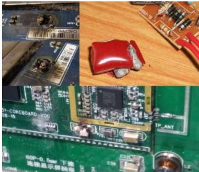
В то время как электролитические конденсаторы можно вычислить по деформированной крышке корпуса или следам протекшего вниз электролита. На крышке конденсатора есть две диагональных борозды, она нужна чтобы корпус не разорвало в аварийной ситуации. Крышка в таком случае вздувается либо трескается. Реже выдавливает дно.
